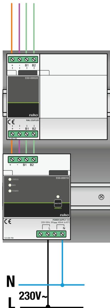
Per voeding (maximaal 3 per installatie): maximaal 24 modulaire Niko Home Control producten in de elektriciteitskast en maximaal 70 bedieningen waarvan 20 met feedback. Raadpleeg de handleiding bij de controller voor meer details.
